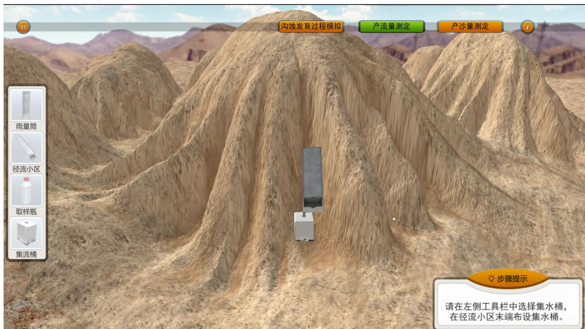
图 48 产流量测定径流小区和集流桶布设
