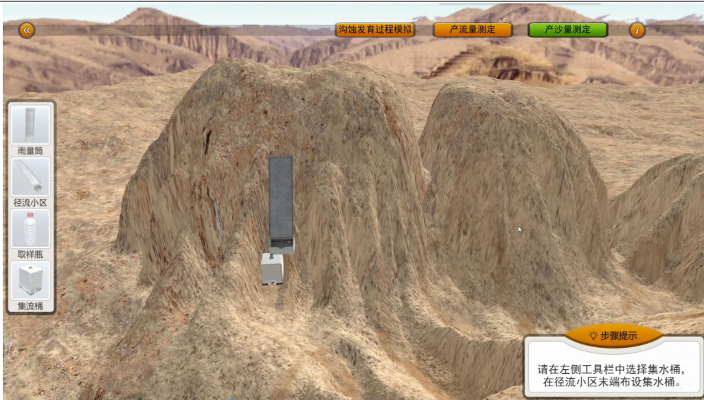
图 53 产沙量测定径流小区和集流桶布设
