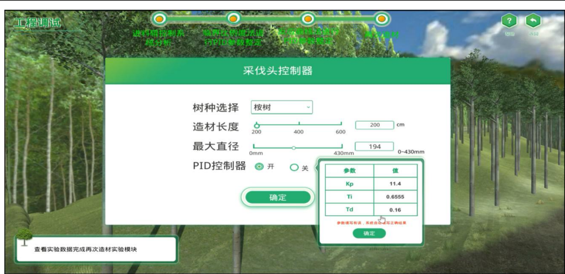
图 2-41 引入 PID 控制器的采伐头控制器界面
