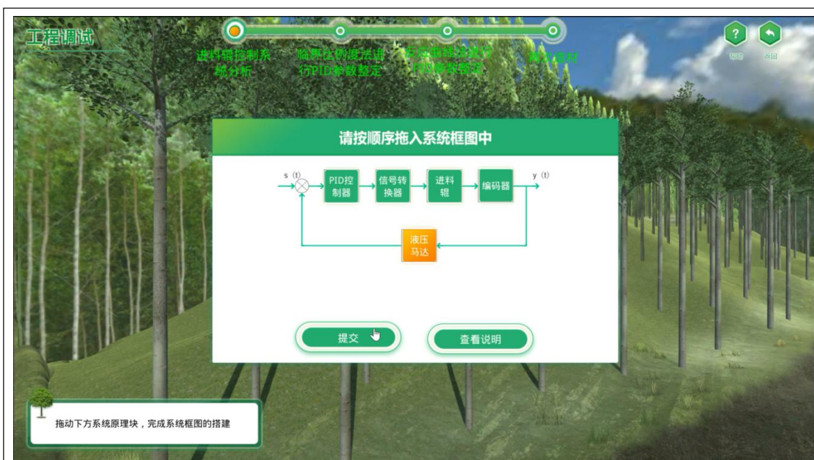
图 2-33 搭建误差反馈模型
