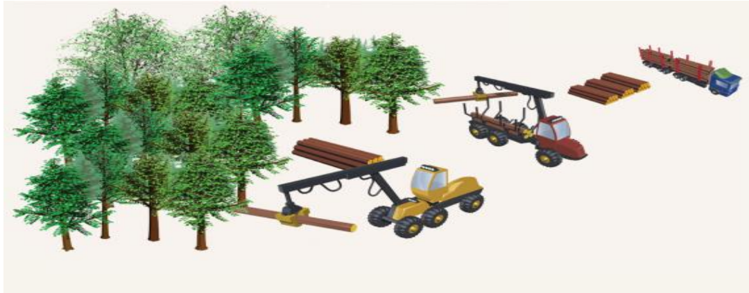
图 2-2 林木联合采伐机作业过程
