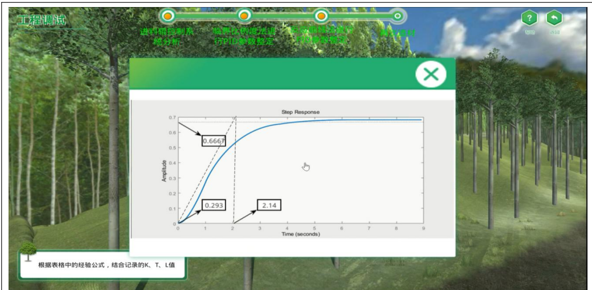
图 2-38 控制对象开环阶跃响应曲线
