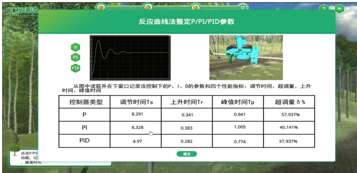
图 2-40 反应曲线法调参界面
